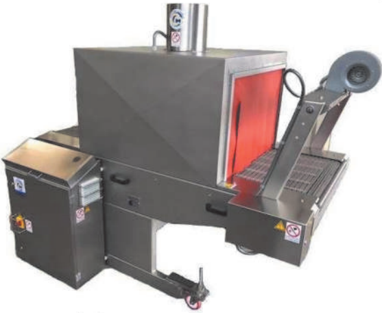
Tunnel di Termoretrazione
